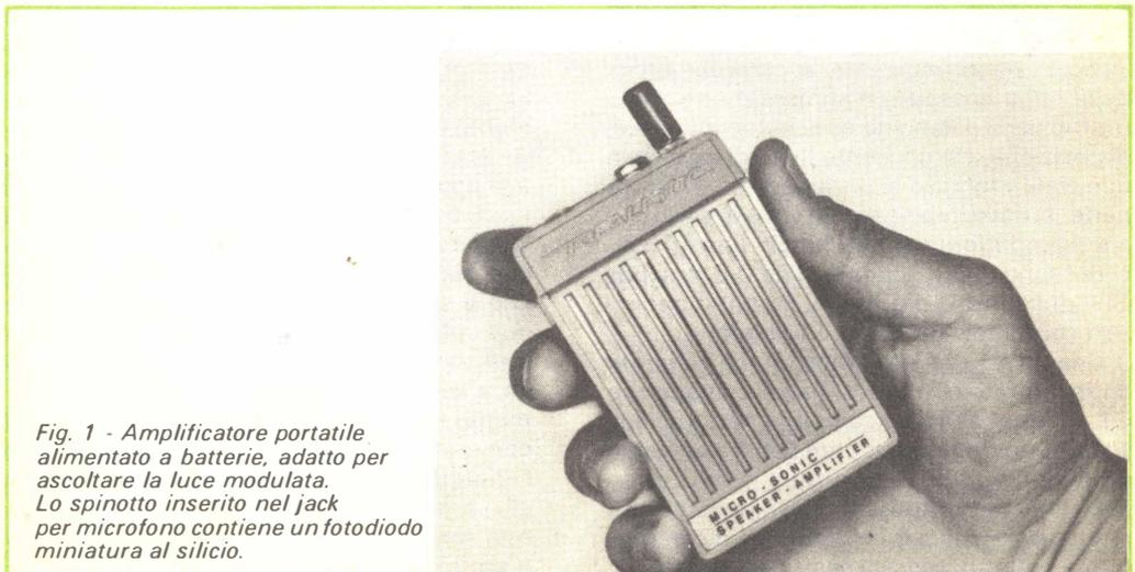
*Fig. 1 - Amplificatore portatile alimentato a batterie, adatto per ascoltare la luce modulata. Lo spinotto inserito nel jack per microfono contiene un fotodiodo miniatura al silicio.*
