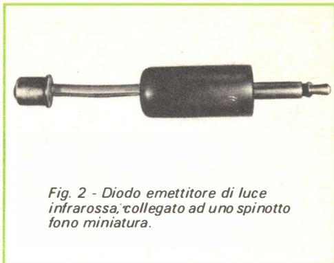
*Fig. 2 - Diode emettitore di luce infrarossa, collegato ad uno spinotto fono miniatura.*
